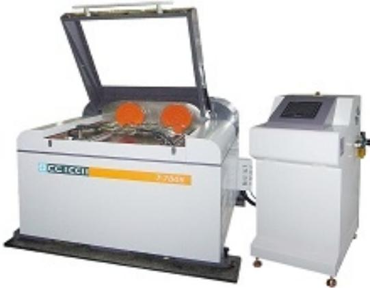
■ Cet équipement simule le cycle de vie des tuyaux assouplis qui sont principalement utilisés dans les voitures et dans les motos pour transporter le fluide hydraulique et la pression d'air.
